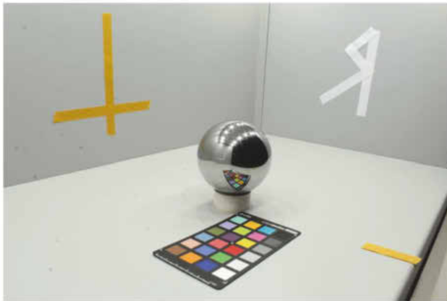
Abb. 3: Durch gekrümmte und stark spiegelnde Oberflächen werden Glanzreflexionen sichtbar. Prototypischer Aufbau der verwendeten Abmusterkabine in diesem Vorhaben.
