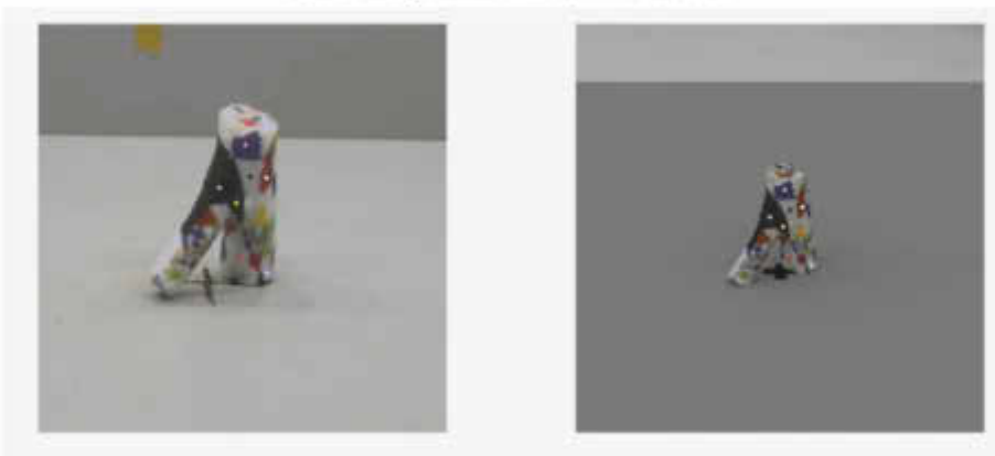
Abb. 8: Bildschirmkopie aus dem Vergleich des Kamerabildes (links, "C") und des Renderings für dieses Objekt (rechts, "B"). Das 3D-Objekt "Baumstamm" wurde mit dem Stratasys J850-Drucker gedruckt.
