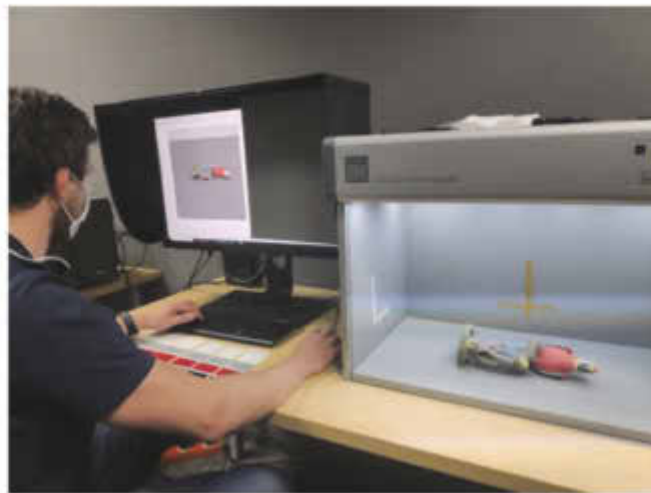
Abb. 9: Proband bei der Durchführung der Glanzbewertung. Vor ihm liegt der Glanzfächer, der ständig betrachtet werden kann. Wichtig ist, dass jeweils nur eine Vorlage, d. h. "A", "B" oder "C" bewertet wird.
