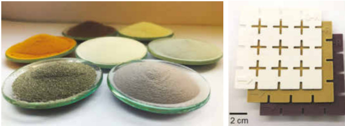
Abb. 2: Links: Mit Nanopartikeln additierte Kunststoffpulver. Rechts: 3D-gedruckte Kunststoff-Geometrien in Farbe.
