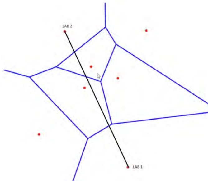
Abb. 10: Darstellung eines Voronoi-Diagramms auf Basis von sechs Farbtönen (rot). Eingezeichnet ist die direkte Verbindung zwischen zwei Farbtönen ( LAB_1 und LAB_2 ), dessen Länge berechnet werden soll. Es ist hier gerade Zufall, dass die beiden Farbtöne die Farbzentren sind.
