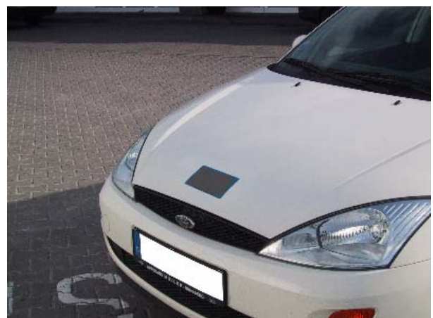
Testfahrzeug mit definierten Verschmutzungen versehen, ...
