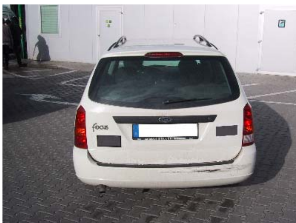
Testfahrzeug mit definierten Verschmutzungen versehen, ...
