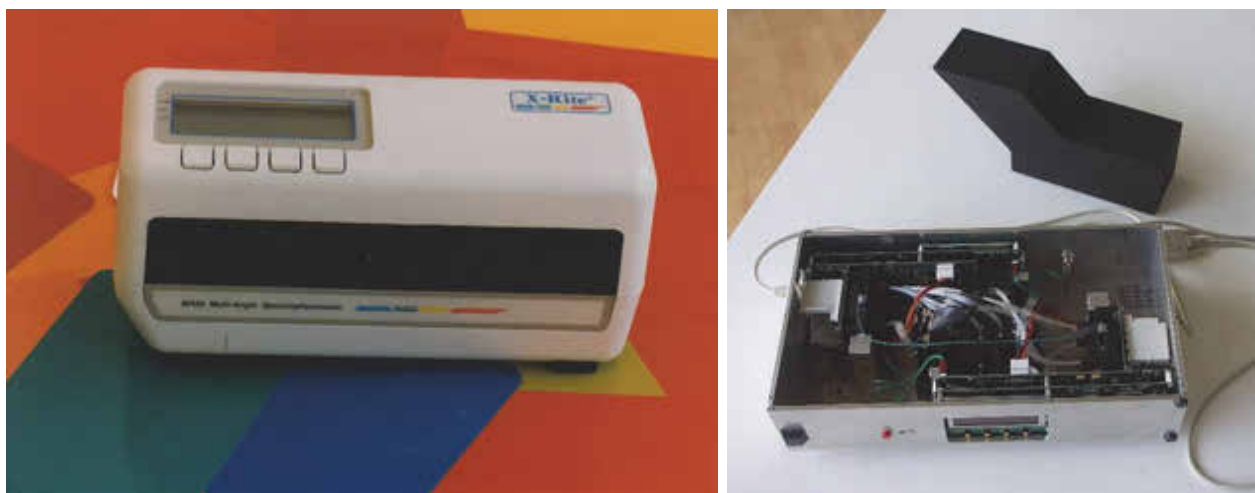
Abb. 8: Das MA-68 war das erste tragbare Mehrwinkel-Messgerät mit einer Beleuchtungs- und fünf Messgeometrien (links). Ein Prototyp als Vorgänger des X-Rite MA98 (rechts).
