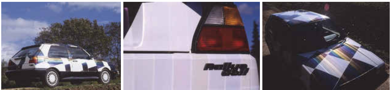
Abb. 1: links: Weißer Untergrund mit schwarzen Flächen und dann Streifen mit verschiedenfarbigen Interferenzpigmenten. Je nach Standpunkt kann mit Reflexions- oder Transmissionsfarben auf diesem Golf erkennen. Mitte: Transmissionsfarben sind deutlich schwächer als Reflexionsfarben zu denen sie komplementär sind. rechts: Bei dieser Kombination von Beleuchtung und Beobachtung sind die Reflexionsfarben über schwarzem und weißem Untergrund zu beobachten.
