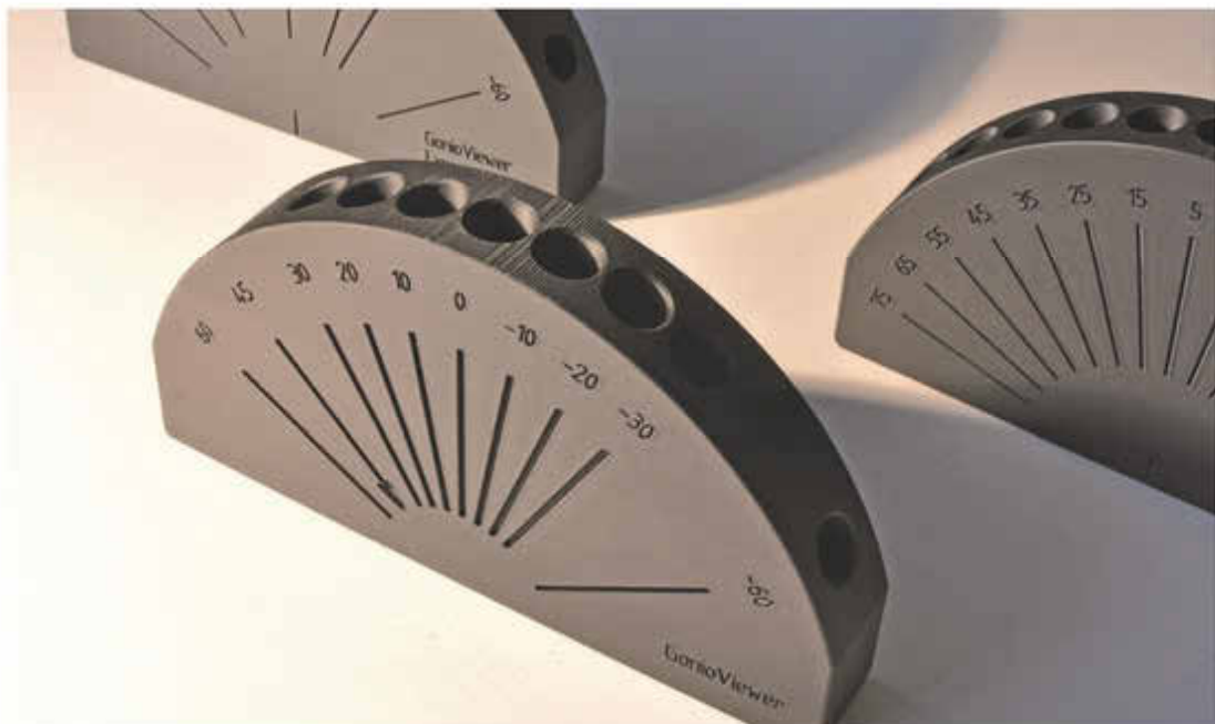
图1：GonioViewer 01具有与当前测量仪器相同的几何形状。额外的几何图形显示了新的干涉颜料的颜色梯度。
