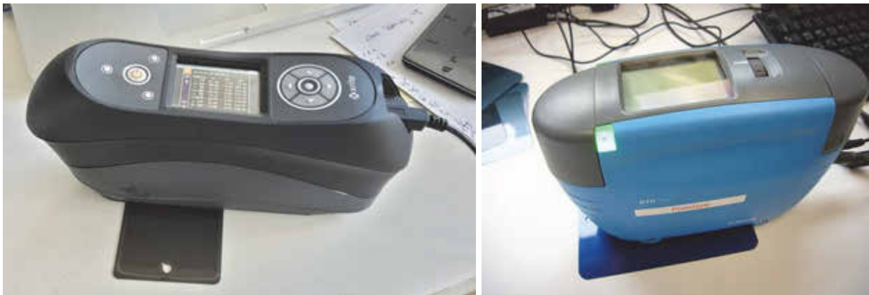
Abb. 9: Zwei Beleuchtungen mit entsprechenden Messgeometrien hatte das MA-98. Außerdem konnte es Out-of-plane messen (links). Das BYKmac mit einer Beleuchtung und sechs Messgeometrien. Zusätzlich werden Sparkle und Graininess bestimmt (rechts).
