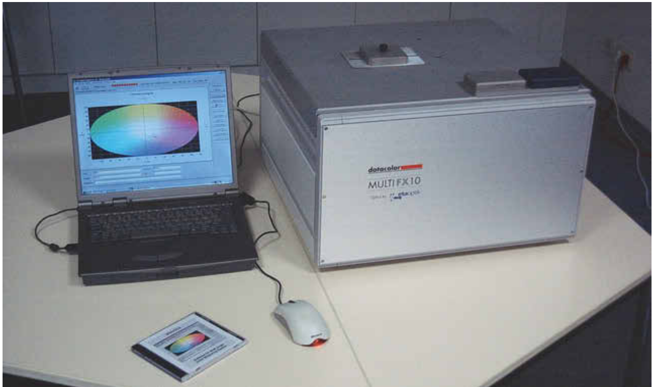
Abb. 10: Einen beweglichen Schlitten mit drei Beleuchtungen besaß das Datacolor MultiFx10.
