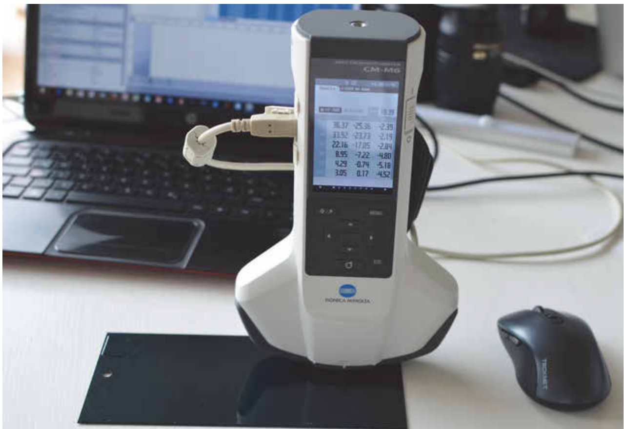
Abb. 11: Das KonicaMinolta CM-M6 besitzt sechs Messgeometrien mit doppelter Beleuchtung von zwei Seiten.
