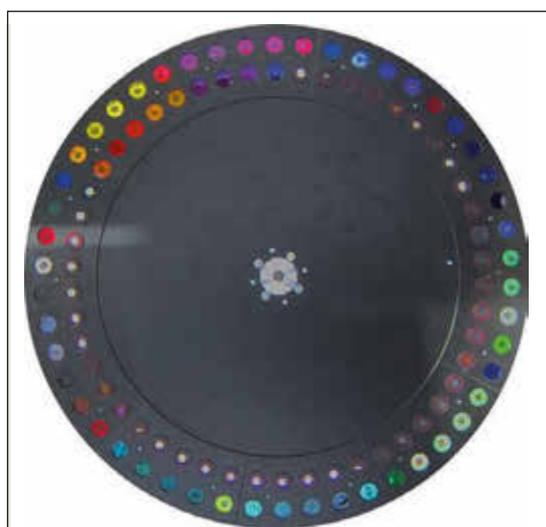
Abbildung 3: Filterrad mit 100 verschiedenen Transmissionsproben
