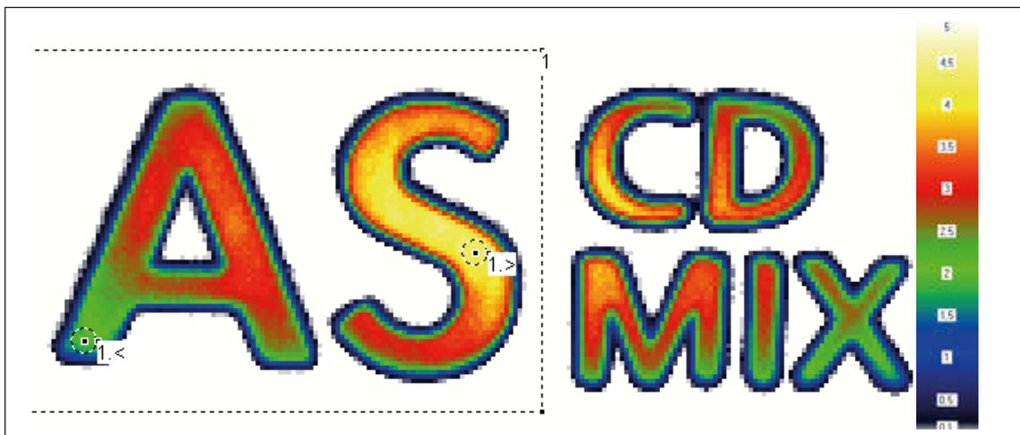
Abbildung 4: Falschfarbendarstellung der Leuchtdichte eines Symbols (Farbpalette rechts). Die Position des Minimums (1.<) und Maximums (1.>) (in Äquivalenz zu einem Punktmesssystem) wird mit kleinen Kreisen markiert.
