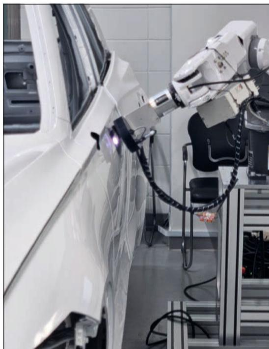
Berührungslose Farbmessung an einer Karosse mit dem spektralen Farbmesssystem colorCONTROL ACS7000 mit einem Ringsensor 45°:0°
