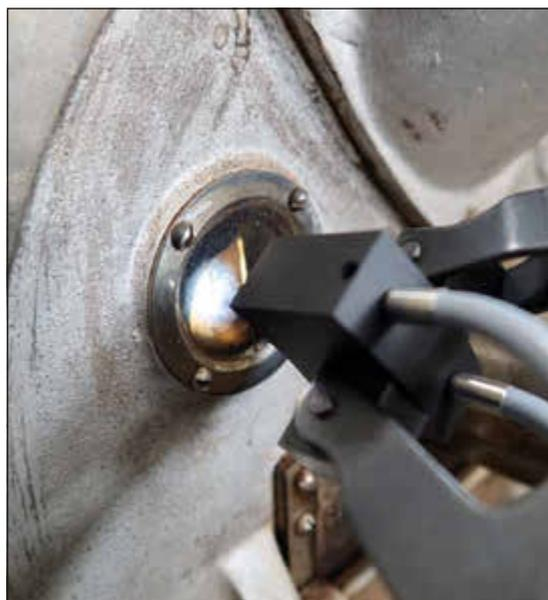
Messung der Farbe in der Röstkammer durch ein Schauglas mit dem relativen Farbmesssystem colorSENSOR CFO200 und Winkelsensor CFS1
