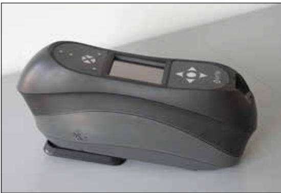
Das X-Rite MA98 mit zweiter Beleuchtung bei  $15^\circ$  und zusätzlichen  $-15^\circ$ -Winkeln vom Glanzwinkel. Und Messgeometrien außerhalb der Ebene von Beleuchtung und Normaler. Heute bietet X-Rite das Nachfolgemodell MA-T12 an.
