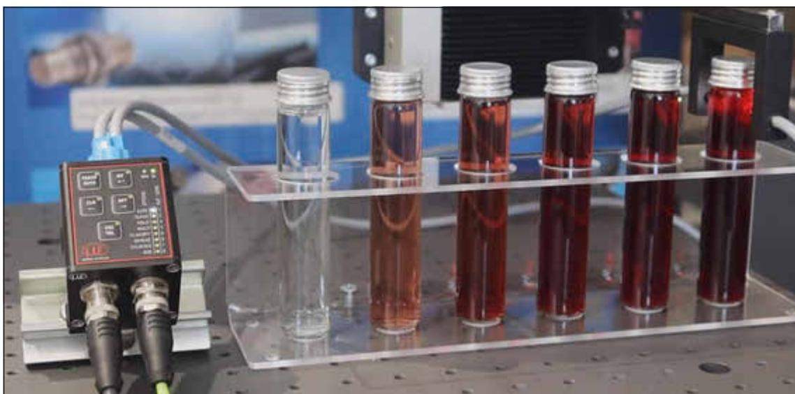
Messung der Eintrübung von Waschwasser mittels relativer Farbmessung colorSENSOR CFO200 mit Transmissionssensor CFS3
