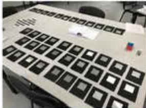
Probenauswahl: alle Proben mittels Aluminiumpigmenten in Druckfarben in Flexo- & Offsetdruck metallisiert
