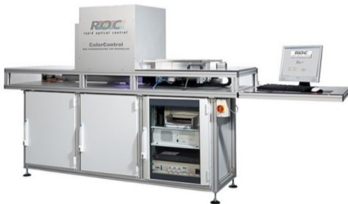
Bild 5: ROC-ColorControl System zur Farbmessung am Granulat [mit freundlicher Genehmigung der ROC Rapid Optical Control GmbH]
