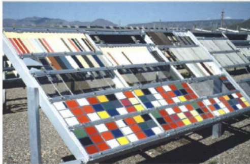
Bewitterungsgestell Ausrichtung 45° Süd
